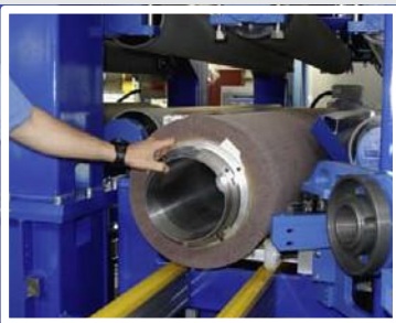
Bürsten von Edelstahl- Coils und Tafeln Brushing of Stainless Steel Coils and Sheets
